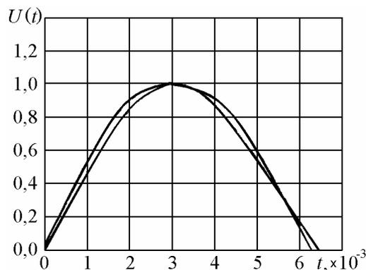
Постоянная времени датчика принималась равной  $T = 0,01$ , коэффициент демпфирования  $\xi = 0,5$ . При моделировании на вход датчика подавался импульсный сигнал в виде полуволны синусоиды  $u(t) = \sin 500t$ . На выходе датчика дополнительно присутствовало приведенное гармоническое одночастотное шумовое воздействие  $v(t) = 0,05 \sin 5000t$ .
