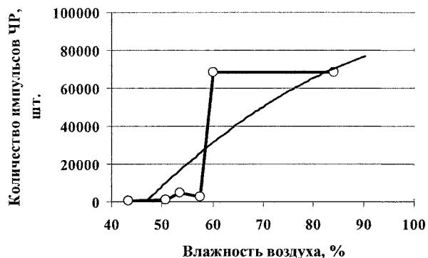
Рис. 3. Зависимость от влажности количества импульсов ЧР на кабельной линии марки ААШВу сечением жил 3x185 мм 2 , длиной 2770 м, 1993 г.
