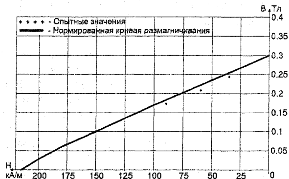
Рис. 9. Сравнительная оценка опытных данных с кривой размагничивания для магнитов прямоугольной формы
