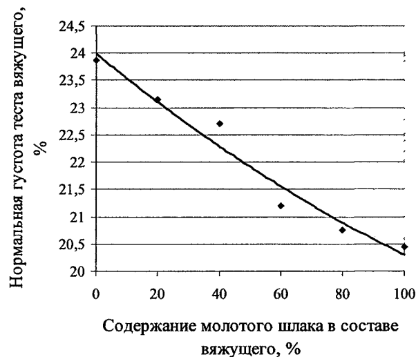
Изменение нормальной плотности цементного теста в зависимости от содержания молотого шлака
