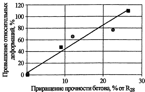
Рис. 4. Превышение относительных деформаций в момент первого загрузки в зависимости от приращения прочности бетона: ■ – бетона без NaNO 2 ; ● – бетона с NaNO 2
