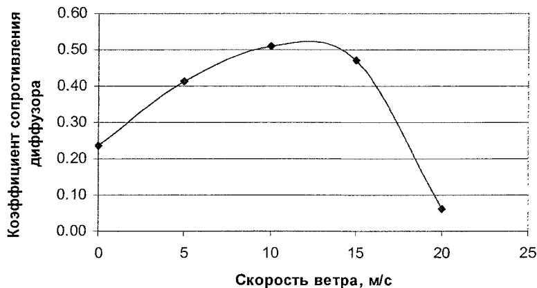
Рис. 1. Изменение коэффициента сопротивления диффузора на выходе из дымовой трубы при L_d/d_1 = 2 , угле раскрытия \alpha = 16^\circ и скорости газов на входе 7 м/с
