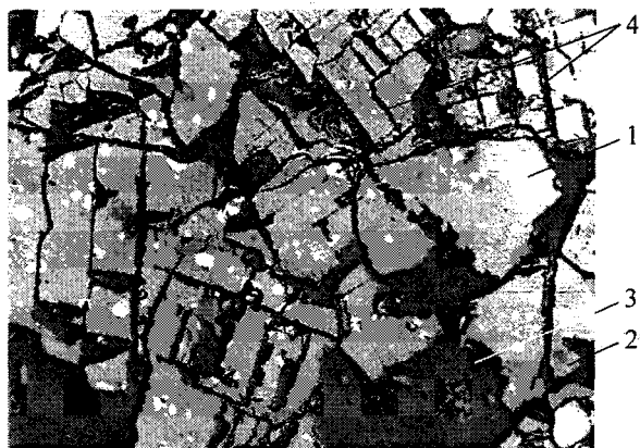
Рис. 5. Микроструктура магнетитового огнеупора. Малоизменная область 2 ряда подины. \times 400 . Без травления. Проба П/526г: 1 – периклаз с включениями магнезиоферрихромитов; 2 – силикаты; 3 – поры; 4 – микротрещины
