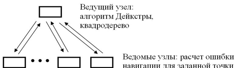
Рис. 6. Схема параллельного алгоритма
