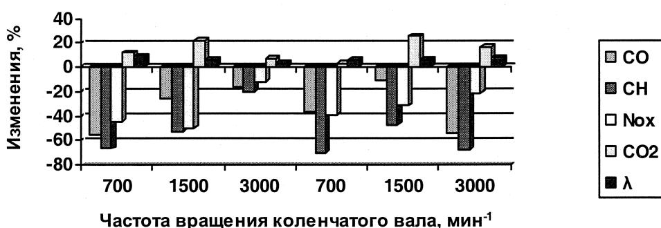
Рис. 4. Изменения компонентов ОГ в зависимости от типа магнитного устройства
