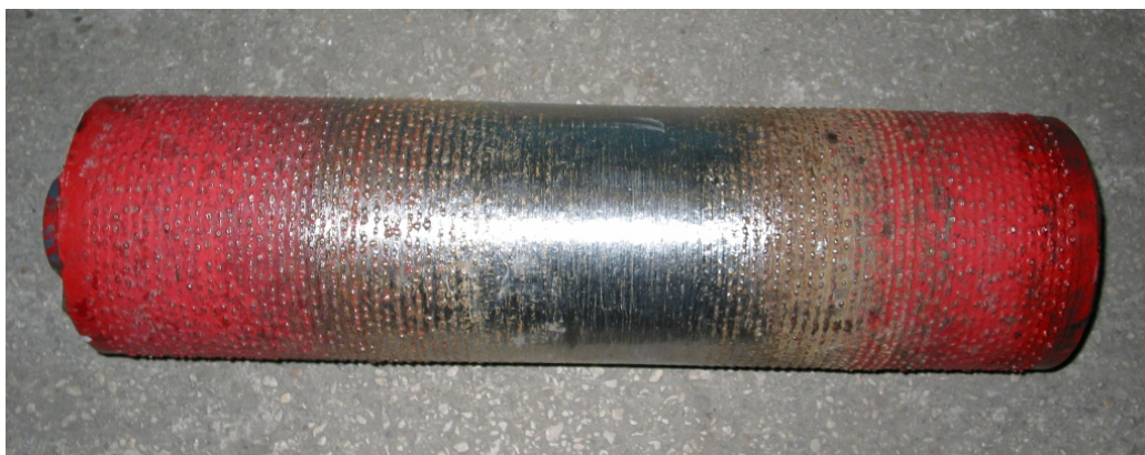
Рис. 1. Ролик стэнда, изношенный колесами автомобилей
