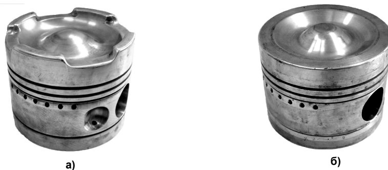
Рис. 1. Поршни дизеля типа ЧН15/18: а – с выточками под клапаны, КС типа Гессельман; б – без выточек под клапаны, КС с увеличенным надпоршневым зазором
