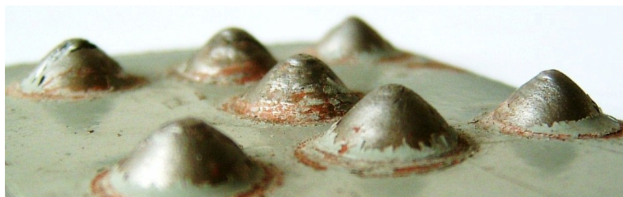
Рис. 7. Заготовка металлического листа с конусообразными шипами, изготовленными методом выдавливания
