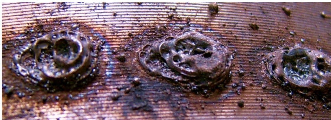
Рис. 3. Цилиндрические шипы с шероховатой поверхностью
