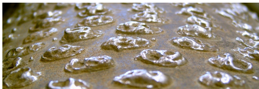
Рис. 5. Шипы в виде коротких валиков на роликах станда «Bilanmatic» фирмы «Muller Bemt»
